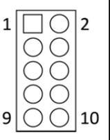
**DIO2: Digital input/output pin header**
